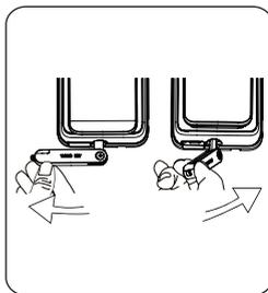
③ 将钥匙套向下旋转180°，使钥匙套平行于水平面。向执手方向水平旋转钥匙套，即可开锁。
