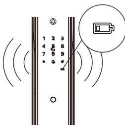
**触发机制:** 当系统唤醒后, 将自动检测电池电压, 当电池电压不足时, 发出警报, 提示您及时更换电池
