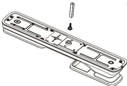
6 将内外面板连接线及锁体连接线插入内面板相应的插座中，再将外面板天线与内面板天线连接好，然后将内面板上的方轴对准锁体上的转动口插入，使内面板紧贴门内面。
