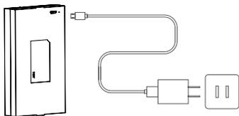
将电池从门锁上取下，使用充电线给锂电池充电。
