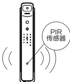
**触发机制:** 当有可疑人员在门外正前方视角范围内, 逗留时长超过设定值将会触发徘徊报警;
