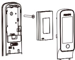
门锁的基础工作电源为一块5000mA/h锂电池。电池盒位于内面板上端，向上滑动电池盖，取下电池盖，即可进行更换电池
