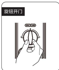
易锁采用室内快开锁体，直接旋转旋钮进行开锁。
