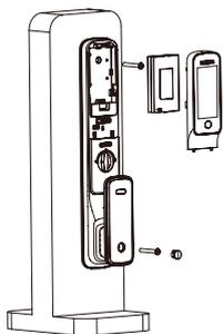
8 安装顶部装饰盖，装上电池，盖上电池盖，装上侧扣板组件之后，智能锁安装完成。
